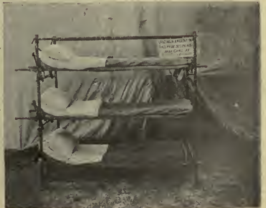
APARATO DE SUSPENSIÓN DE GAMILLAS PARA LOS FERROCARRILES
