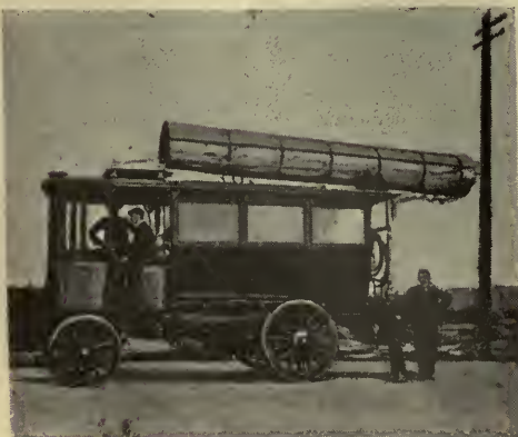
EL TELÉGRAFO MARCONI EN LA GUERRA.—CARROS PARA LA TRANSMISIÓN Y RECEPCIÓN
