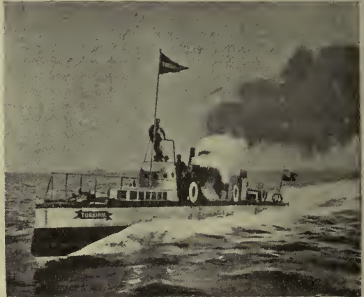
LOS TORPEDEROS «VIPER» Y «TURBINIA», CON MÁQUINAS SISTEMA TURBINA Y UN ANDAR DE 37 MILLAS POR HORA
