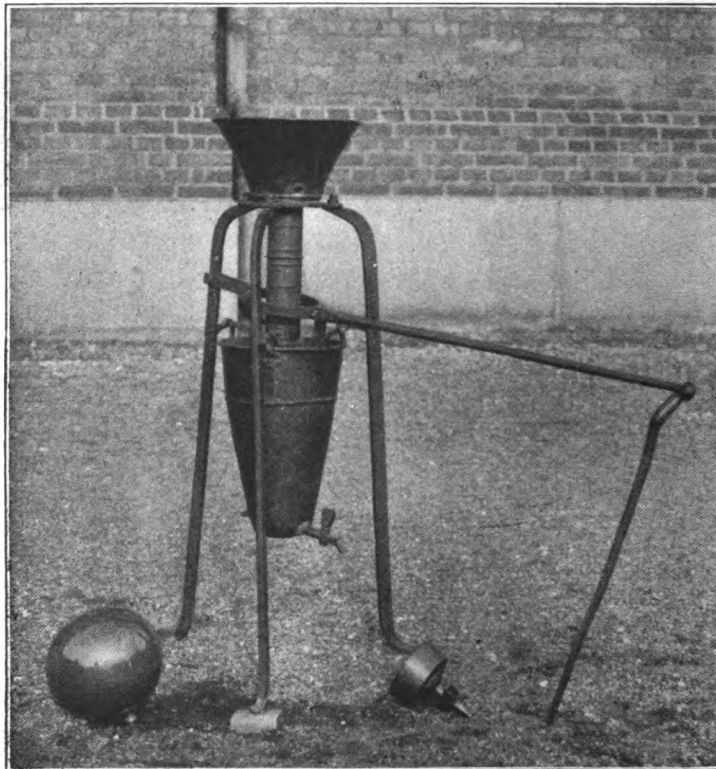
Die in Lund befindliche Luftpumpe OTTO VON GUERICKE's.
