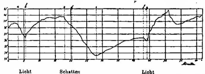
Die Temperatur zeigte vor dem Versuch 35°. Die ersten Minuten verstrichen mit Einstellung in den Lichtkegel. Darauf fand Anschliessung des Lichtes mittels eines Schirmes statt (a), während das Druckglas auf seinem Platz blieb. Die Temperatur begann zu fallen.
