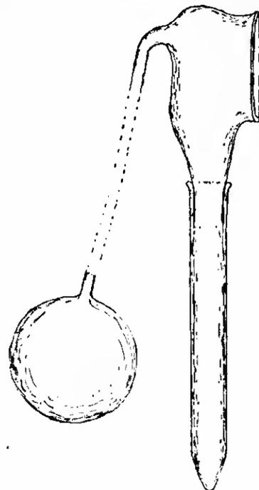
dass ich das Glasgefäss nach unten hin konisch verlängert und daran ein abnehmbares Glasröhrchen mit geringem Querdurchmesser anschleifen liess.
