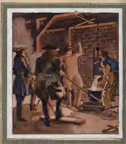
BILD 98: EISENGIESSEREI. In der Gewinnung und Verarbeitung des Eisens hat Deutschland stets an hervorragender Stelle gestanden. „Hohe Ofen“ waren bereits im Mittelalter in Betrieb. Während man damals das Eisen noch unmittelbar aus dem Hochofen in Behältern goss, fing man gegen Ende des 17. Jahrh. an, den eigentlichen Eisenguß und die reine Eisengewinnung im Hochofenprozeß voneinander zu trennen.
