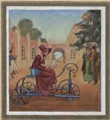
BILD 214: DRAISINENFAHREN. Die Draisine ist nicht eigentlich das Fahrrad, sondern eher der „Sitz-Roller“ der Romantik. Die Draisine (nach ihrem Erfinder Karl von Drais, der sie 1817 in Mannheim zuerst konstruierte), ist das alte Holzrad ohne Tretkurbeln. Der Fahrende saß auf einem sattelähnlichen Sitz und bewegte sich vorwärts, indem er abwechselnd zwei mit den Rädern verbundene Bretter trat.
