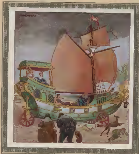
BILD 115: SEGELWAGEN. Der Segelwagen ist eine zuerst im 16. Jahrh. auftauchende technische Erfindung, die die Kraft des Windes dem Fahren auf dem Lande nutzbar machen wollte durch ein Segelschiff auf Rädern. Dieser „Lustwagen“, nur zu Fahrten am Ufer benutzbar, war mehr eine lustliche Liebhaberei. Praktische Verwertung hat das gleiche-Prinzip erst bei den auf Kufen laufenden Segelschiffen erlangt.
