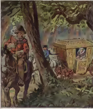
BILD 57: REISEWAGEN. Der vornehme Reisewagen der Renaissance glich einer auf Rädergestell gesetzten Sänfte. Seine mangelnde Federung machte das Fahren auf den holperigen Landstraßen oft zur Qual. Da er kein aufklappbares Verdeck und nur eine kleine seitliche Öffnung hatte, war er ein recht dunkler, stickiger Aufenthalt. Zur Sicherheit der Reisenden begleiteten meist Vor- und Nachreiter den Wagen. (Vgl. I 56.)
