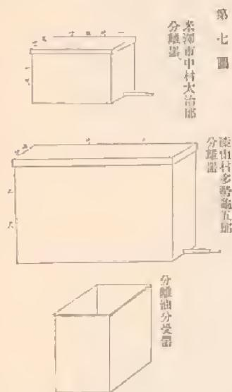
Fig. 49. Blechkasten zur Abscheidung des Menthols.
