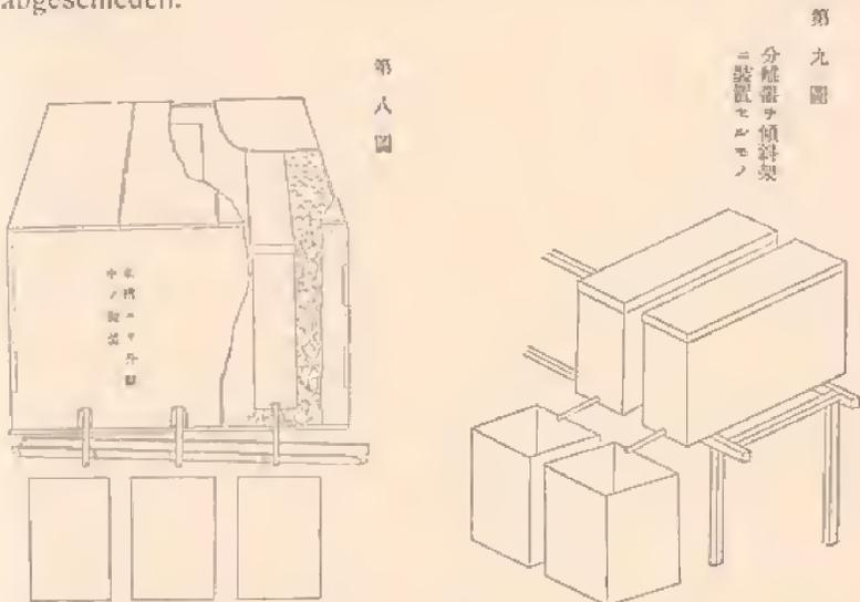
Fig. 50. Anordnung der Kästen im Eisschrank.
