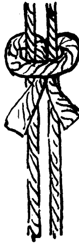
Fig. 4. — Point noué sur 2 fils de chaîne. (Rabat et Asie mineure).
