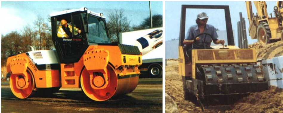
Fig. 16.6 – Maquinaria de compactación de terraplenes
