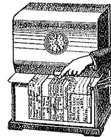
Jede für irgendeine bezahlte Arbeit aufgewendete Periode von 3 Minuten wird registriert und einem produktiven oder unproduktiven Fabrikauftrag belastet. Die geschickte Auswertung der Aufzeichnungen bringt die verborgensten Verlustquellen an den Tag. Die Endzeit einer Operation ist gleichzeitig Anfangszeit der folgenden, was die Meister zur Arbeitsvorbereitung zwingt.
