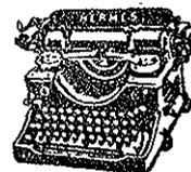
vollkommen sichtbar. Klaviatur auf 46 Tasten = 92 verschiedene Zeichen erweitert. Die Typenhebel laufen in einem Segment und besitzen Zentralführung, doch ist jeder Hebel einzeln regulierbar. Daher die saubere gleichmäßige Schrift. Um der Maschine einen gleichmäßigen, ruhigen Gang zu geben, rotiert das Schaltband auf Kugellagern, und die
