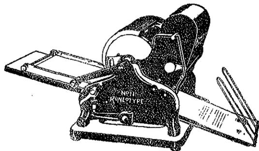
an hergestellt. Automatische Einfärbung und Einschub von Löschpapier, so daß jedes Papier verwendet werden kann. Die Klischees werden auf der Schreibmaschine hergestellt und können auch später immer wieder verwendet werden. Lieferung für Hand- und elektrischen Betrieb.
