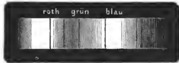
Absorptionsspectrum des violetten Manganglases.
