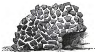
Opus Incertum. Concrete. The Emporium, B.C. 175.
