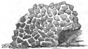
Opus Incertum Concrete. The Emporium, B.C. 175.
