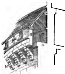
A. Alur. B. Parapet. M. Machicolation.
