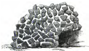
Opus Incertum. Concrete. The Emporium, B.C. 175.
