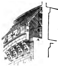
A. Alur. B. Parapet. M. Machicolations.
