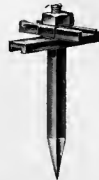
Method of securing teeth. Façon dont les dents sont fixées. Modo de sujetar los dientes.
