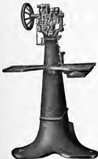
(IB) "Standard" Welt and Turnshoe Sewing Machine. Machine "Standard" (type normal) à coudre les trépointes et le retourné ou cousu chaousson. Máquina "Standard" para empalmillar y coser escarpín.
