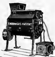
Tamiseur, mélangeur et pulvérisateur pour les poudres à condimenter ou à parfumer. Cernidor, mezclador y pulverizador para polvos para sazonar o para perfumar.
