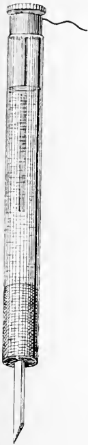
Fig. 229. Unpolarisierbare Elektrode, die statt des Pinsels eine Spitze aus gebranntem Thon trägt.
