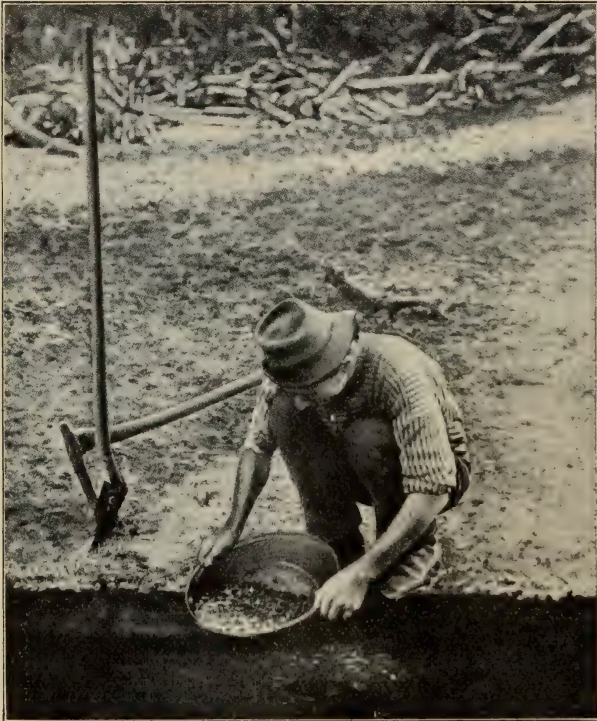
Waschen goldhaltigen Erdbreichs mit der Schüssel, „Dish-washing“, in Australien. (Nach Photographie.)
