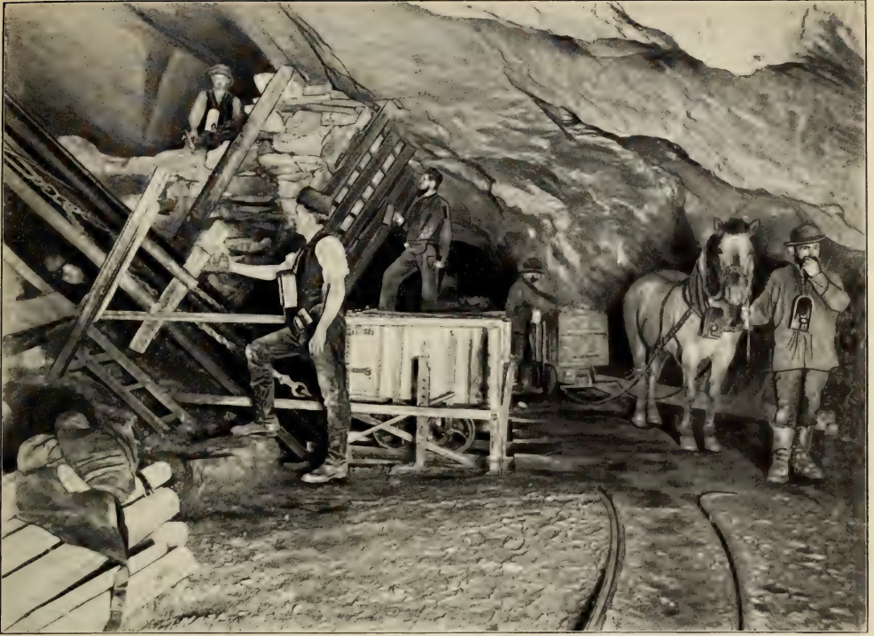
4. Förderung im flachen Schacht (Bremsberg), Streckenförderung mit Pferd. Freiberg. Nach Photographie von H. Boerner in Halle a. S.
