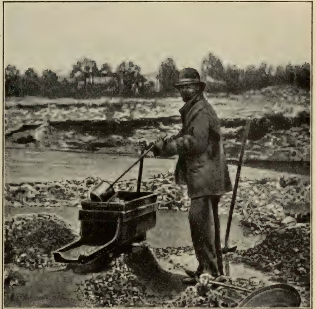
Waschen goldhaltigen Erdreichs mit der Wiege, „Cradling“, in Australien. (Nach Photographie.) Vgl. Text, S. 316.
