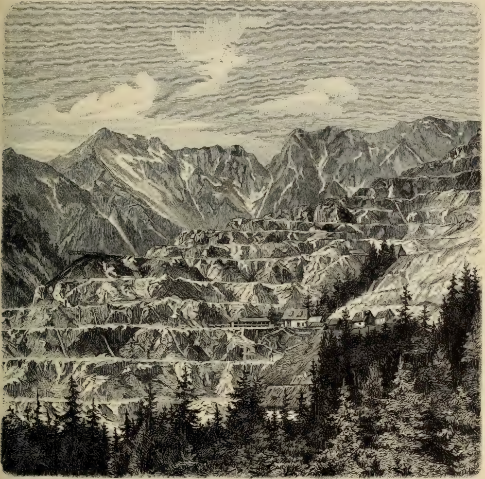
Stufenbau am Erzberg in Eisenerz, Steiermark (Abbau des Eisenspatz von Tag aus). Vgl. Text, S. 266.
