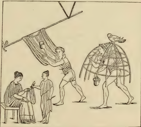
10. Walkerei der Römer; (von rechts nach links:) Gerüst zum Schwefeln, das Rauhen d. Stoffs, Ablieferung d. fertigen Stoffs.
