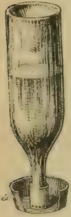
Fig. 101. Nourrisseur de M. Malessard. a. Récipient en métal dans lequel le sirop s'écoule par les petits trous de l'armature du goulot, sans en dépasser jamais le niveau.
