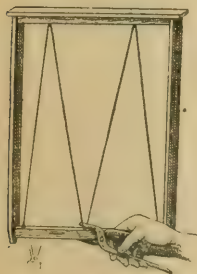
Fig. 40 bis. — Tension des fils placés en hauteur.
