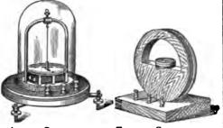
ABTATIC GALVANOMETER. TANGENT GALVANOMETER.
