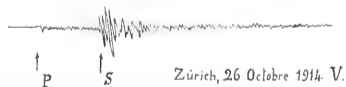
FIG. 2 — Sismogramme du tremblement de terre du 26 octobre 1914, au nord de Turin, à 260 km de distance. Enregistré à Zurich par la composante verticale du sismographe Spindler & Hoyer-Wiechert. — Période du maximum 2.5 sec amplitude totale maximum 0.15 mm. Durée de S — P = 32 sec. — Ressenti à Zurich.
