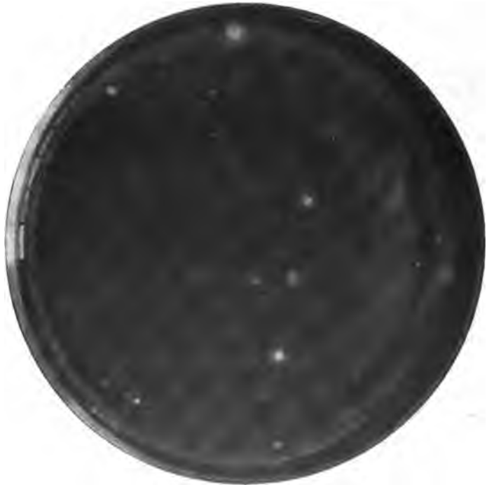
Fig. 5. Gelatineplatte während Zimmerreinigung durch Vakuumreiniger. 20 Minuten der Luft ausgesetzt.
