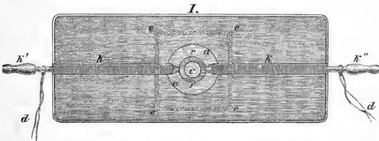
In die Mitte eines aus dickem Spiegelglase geschnittenen Objectträgers wird eine kreisförmige Rinne ( $r r$ ) eingeschliffen; von dieser Rinne aus wird nun weiter von zwei diametral gegenüberstehenden Polen derselben je ein Halbcanal geschliffen, so dass beide in eine gerade Linie zu liegen kommen, und der ganzen Längsmittellinie des Objectträgers entlang laufen mit Ausnahme der Stelle, wo die Kreisrinne ist und mit welcher die Halbcannäle communiciren.
