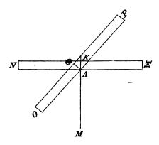
γὰο γίνεται τοῦ ἡμίσεος τοῦ ζυγοῦ τὸ κάτω μέρος ἢ ὡς ἡ κάθετος διαιρεῖ, ὥστε οὐκ ἀναφέρεται: κουφότερον γὰρ τὸ 10 ἐπηρτημένον. ἔστω ζυγὸν τὸ ἐφ' οδ ΝΞ, τὸ ὀρθόν, κάθετος 25 δὲ ἡ ΚΛΜ. δίχα δὴ διαιρεῖται τὸ ΝΞ. ἐπιτεθέντος δὲ βάρους ἐπὶ τὸ Ν, ἔσται τὸ μὲν Ν, οδ τὸ Ο, τὸ δὲ Ξ, οδ
