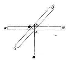
γὰρ γίνεται τοῦ ἡμίσεος τοῦ ζυγοῦ τὸ κάτω μέρος ἢ ὡς ἡ κάθετος διαιρεῖ, ὥστε οὖκ ἀναφέρεται κουφότερον γὰρ τὸ 10 ἐπηρτημένον. ἔστω ζυγὸν τὸ ἐφ' οὖ ΝΞ, τὸ ὀρθόν, κάθετος 25 δὲ ἡ ΚΛΜ. δίχα δὴ διαιρεῖται τὸ ΝΞ. ἐπιτεθέντος δὲ βάρους ἐπὶ τὸ Ν, ἔσται τὸ μὲν Ν, οὖ τὸ Ο, τὸ δὲ Ξ, οδ
