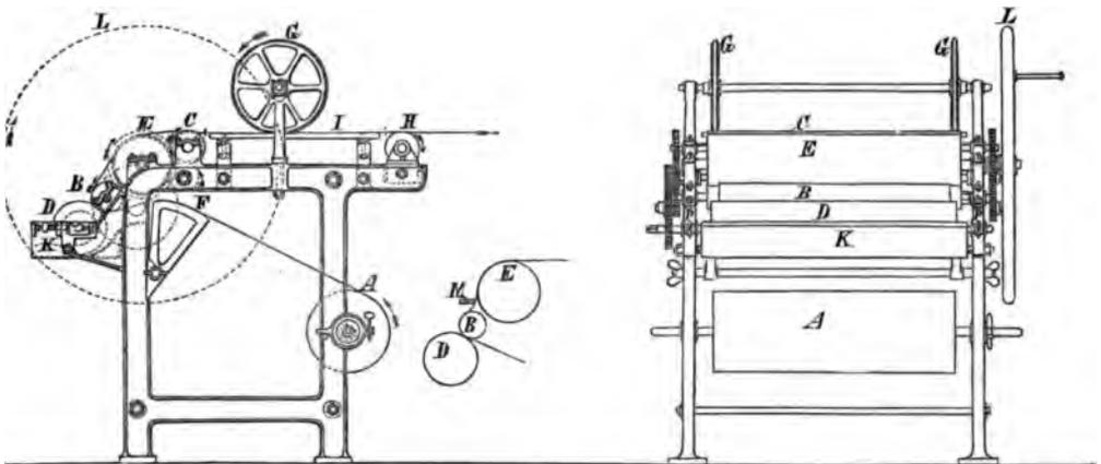
Fig. 78. Maschine zum Präpariren von Lichtpauspapier.
