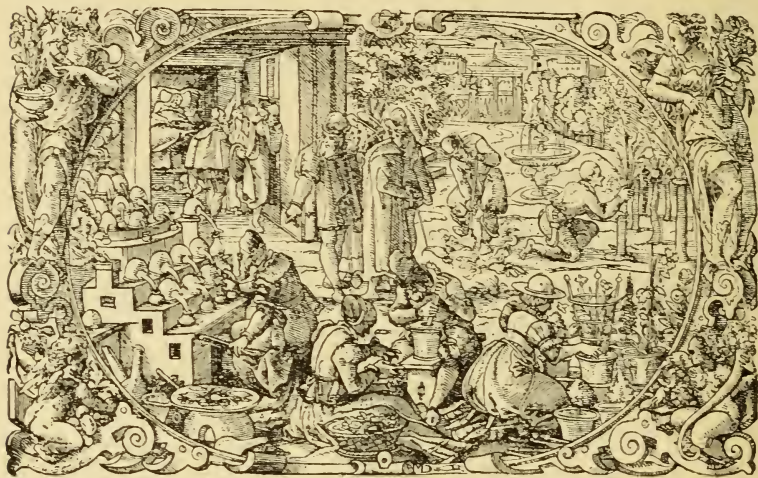
Fig. 98. Staffelförmiger Destillierherd nach einem Holzschnitte vom Jahre 1592.
