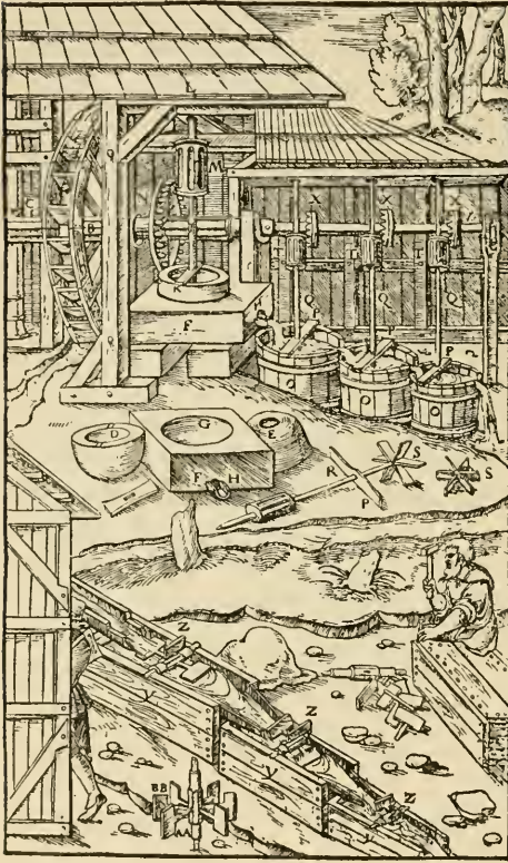
Fig. 22. Goldgewinnung mittels Amalgamationsverfahrens nach einem Holzschnitte vom Jahre 1557.
