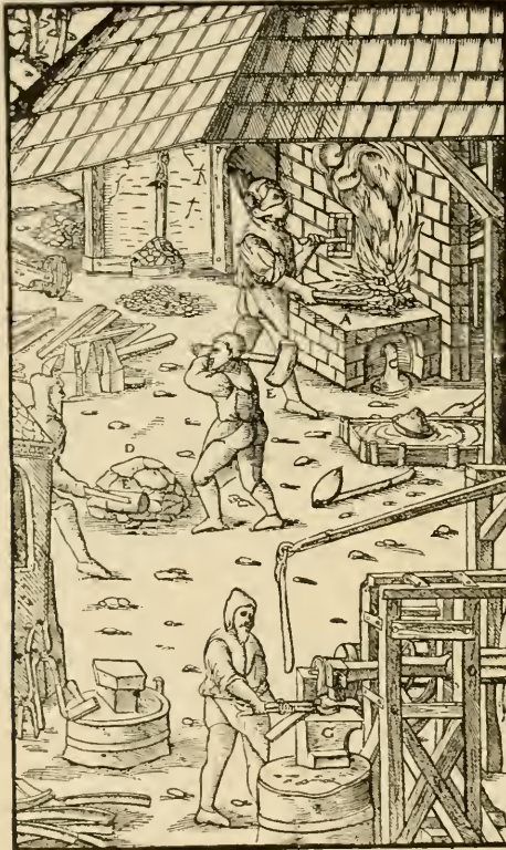
Fig. 39. Herd zur Ausschmelzung von Eisenerzen und Hammerwerk nach einem Holzschnitte vom Jahre 1557.
