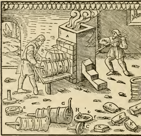
Fig. 37. Schmelzofen für Zinnerze nach einem Holzschnitte vom Jahre 1557.
