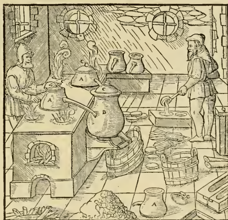
Fig. 49. Gewinnung von Schwefel durch Destillierung nach einem Holzschnitte vom Jahre 1557.
