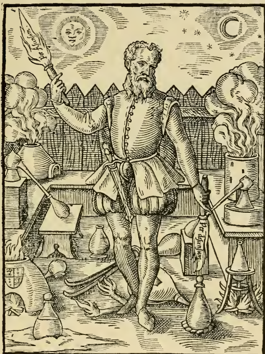
fig. 48. Darstellung von Schwefel durch Ausschmelzung und durch Sublimation nach einem Holzschnitte vom Jahre 1574.
