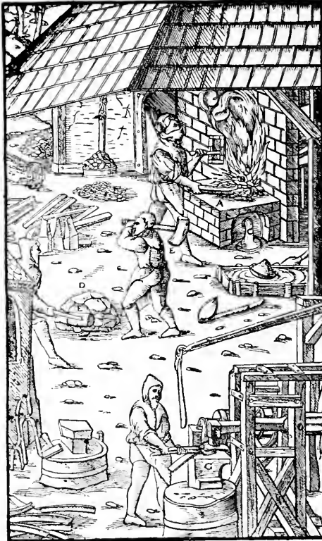
Fig. 39. Herd zur Aus schm elzung von Eisenerz und Hammerwerk nach einem Holzschnitte vom Jahre 1557.
