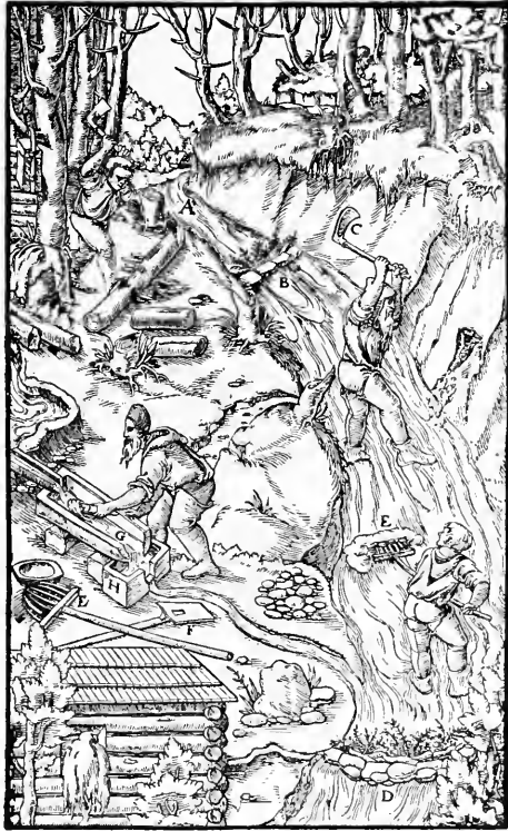
Fig. 36. Auswaschung von Zinngraupen nach einem Holz- schnitt vom Jahre 1557.
