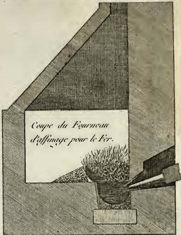
Plan du Fourneau d'affinage pour fabriquer le Fer en Karinthie.
