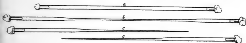
FIG. 35.—Method of making a Pasteur pipette.
