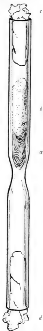
FIG. 30.—Air-filtering tube; actual size.
