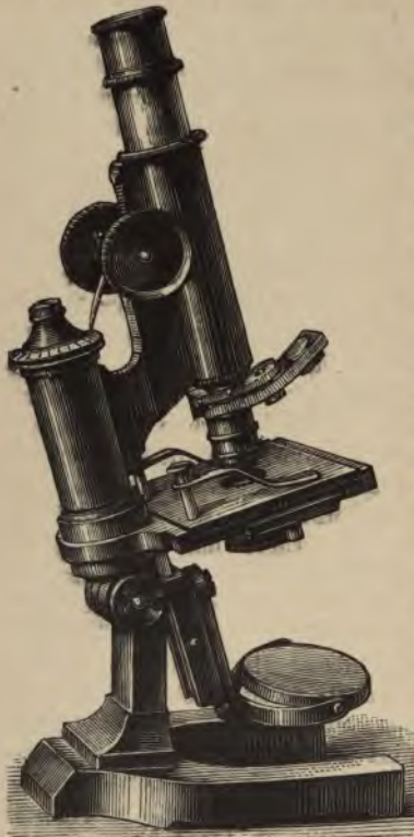
Fig. 1. Mikroskop neuerer Konstruktion mit Abbé'schem Beleuchtungsapparat und Ölimmersion.
