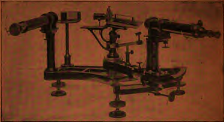
Interferenzspektroskop nach Lummer-Gehrcke, geliefert an die Physikalisch-tech. Reichsanstalt.
