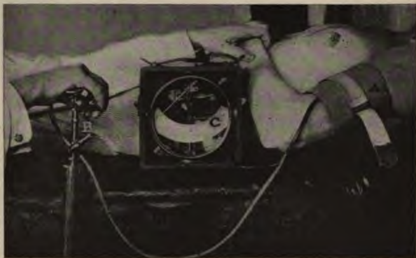
FIG. 61.—The von Recklinghausen tonometer: A , cuff; B , pump; C , tonometer dial.
