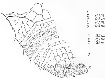
Fig. 1.—Corte en la boca-mina del socavón cerca del manantial en el Valle del Arco. 1. Granodiorita. 2. Granodiorita transformada en roca de granate. 3. Roca de granate granulosa. Escala 1 : 60.
