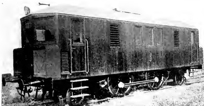
Dieselmotorlokomotiv med hydraulisk kraftöverföring, system G. Rosén.
