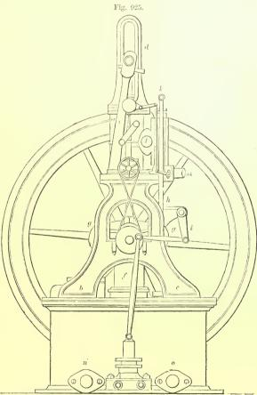
SIDE ELEVATION OF CARREFT'S STEAM-PUMP AND FORTABLE STEAM-ENGINE.
