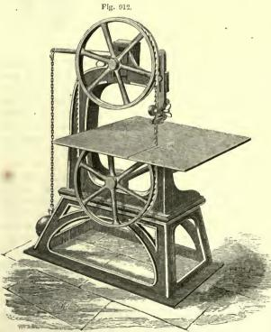
ENDLESS BAND SAW FRAME IN PERSPECTIVE.
