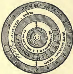
Fig. 176.—ILFORD EXPOSURE METER
