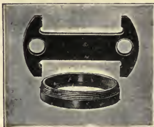
Fig. 540.—CALLIPER LIMIT GAUGE.
