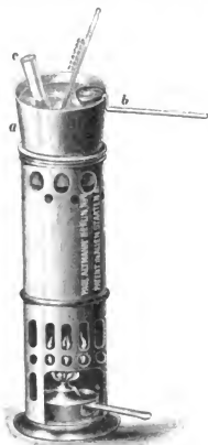
Apparat zur Butteruntersuchung nach Jahr.
