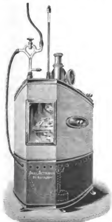
Thermostat für Mikroskope nach Nuttall.
