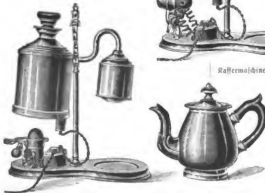
Kaffeemaschine mit selbstthätiger Schaltvorrichtung (Fig. 8 b).
