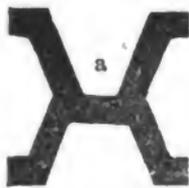
Die Fläche a in der oberen Vertiefung liegt im geometrischen Mittel des in der Grundform quadratischen Stabes; auf ihr wird die Theilung aufgetragen. Nun soll ein getheilter Normal-Maassstab aus Bergkrystall angefertigt werden, welcher in diese Vertiefung von oben her kann eingelegt werden.
