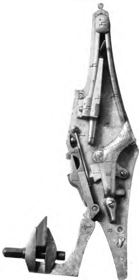
Fig. 70. Deutsches Radschloß, Innenseite. a Schloßblech, b Pfanne, e Studel, f Hahn, h Schlagfeder (h' Kropfen, h'' Deckplatte, h''' Backen), i Stange (i' Stangenkopf), i Pfannenschieber (i' Arm, i'' Feder des Pfannenschiebers).
