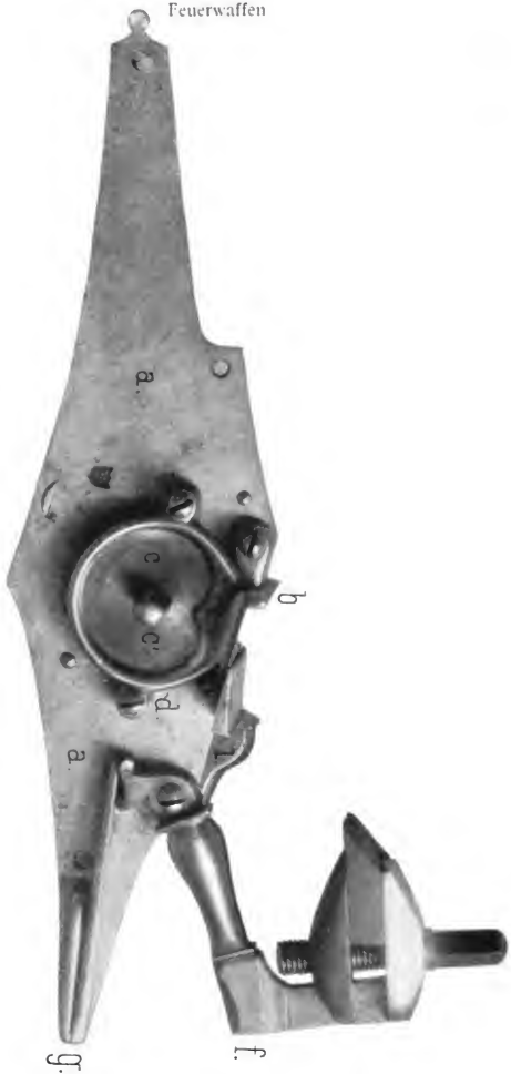
Fig. 69. Deutsches Radschloß, Vorderseite. a Schloßblech, b Pfanne, c Rad, c' Vierkant, f Hahn, g Hahnfeder, l Pfannenschieber.
