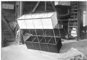
Fig. 4. Moderner Drache nach Hargrave mit gekrümmten Flächen (nach Helm-Cleyton).
