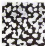
Fig. 21. Kombiniertes Netz-Kornraster. Kombiniertes Punkt-Kornraster.
