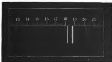
Fig. 312 erläutert, wie die verschiedenen Spectrallinien an verschiedenen Stellen der Scala erscheinen, so z. B. die gelbe Natriumlinie bei 18,25 (oder auch 182,5), die rothe Lithiumlinie bei 20,24 (oder auch 202,4) u. s. w. (Näheres im Lehrbuch und in den Nachträgen zur 2. Auflage des Supplementbandes.)
