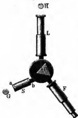
*F* hineinschauend erblickt man also das Bild dieser Scala auf das Spectrum der Flamme projectirt, welche bei *H* aufgestellt ist.
