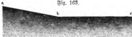
schiefer Ebene herabrollend bei  $b$  mit einer Geschwindigkeit von 30 Fuß in der Secunde an, so ist leicht zu berechnen, wie weit er noch auf der horizontalen Bahn fortrollen wird, ehe er zur Ruhe kommt, wenn die Reibung  $\frac{1}{300}$  der Last ist. Nach der Formel  $s = \frac{v^2}{2g}$  ist die Höhe, zu welcher er vermöge der
