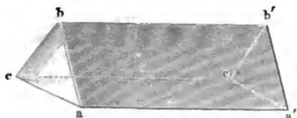
Licht durch die Flächen  $ab'$  und  $ac$  hindurchgeht, so ist  $aa'$  die brechende Kante und die Fläche  $bc'$  die Basis;  $bb'$  ist brechende Kante, wenn der Lichtstrahl durch die Flächen  $ba'$  und  $bc'$  geht u. s. w.
