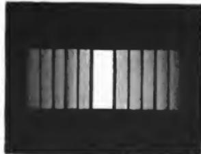
geschwärzten, in die Sonne gelegten Glasröhre, welche dem Spalte parallel ist, so beobachtet man die Erscheinung Fig. 344. In der Mitte des Bildes sieht man einen hellen Streifen, zu beiden Seiten aber schmalere Farbenstreifen, die nach außen hin immer lichtschwächer werden.
