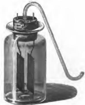
beiden Polplatten ein solches Glöckchen befindet. Sobald man nun die Drähte *f* und *f'* mit den Polen der Säule in Verbindung bringt, entwickeln sich Gasblasen in reichlichem Maße. Keines Sauerstoffgas steigt immer in dem Glöckchen über dem positiven Pole auf, das Wasserstoffgas im anderen.
