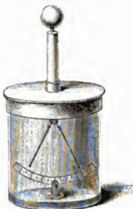
die von  $r$  abgestoßene Elektrizität in die Pendel herabgetrieben, die von  $r$  angezogene aber in die Platte des Elektroskops heraufgezogen wird.
