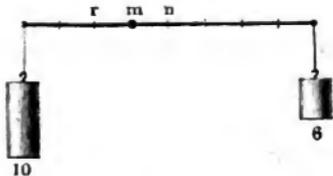
Zu Fig. 15 sei die Kraft rechts = 6, ihr Hebelarm = 5, so ist das statische Moment dieser Kraft gleich  $5 \times 6 = 30$ ; soll ihr die Kraft links das Gleichgewicht halten, so muß das statische Moment beider gleich sein; die an dem Hebelarme 3 auf der linken Seite wirkende Kraft muß also den Werth 10 haben.
