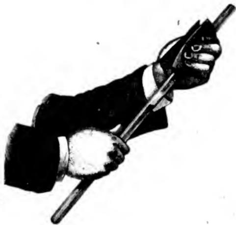
der Kautschukplatte, indem man dieselbe nur in einem Eck zwischen zwei Fingern festhält, einem negativ elektrischen Streifen von Pyropapier, so wird derselbe abgestoßen; die Kautschukplatte ist also negativ elektrisch, während der Glasstab sich als stark positiv elektrisch erweist.
