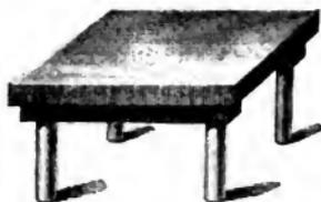
genannten Isolirschmel, Fig. 382, d. h. auf einem durch Glasfüße getragenen Brette, steht, so wird der ganze Körper elektrisch. Man sieht jetzt auch ein, warum eine Metallstange, die man in der Hand hält, durch Reiben nicht elektrisch wird; alle Electricität nämlich, welche man durch das Reiben auf dem Metalle erzeugt, wird sogleich durch den menschlichen Körper wieder abgeführt.
