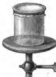
gewicht und drückt die Blase nach innen. Letzteres läßt sich leicht mit Hilfe der Luftpumpe bewerkstelligen. Bei den ersten Kolbenzügen schon wird die Blase nach innen gekrümmt, Fig. 108; je mehr man auspumpt, desto mehr nimmt die Krümmung zu, bis sie endlich in Stücke reißt, wobei man einen Knall wie einen Pistolenschuß hört. Dieser Knall wird durch das heftige Eindringen der Luft hervorgebracht.
