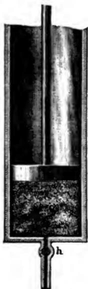
100° erwärmt ist, während der Cylinder selbst sich in einer auf 100° erwärmten Umgebung befindet. Wird nun ein Kolben, welcher ursprünglich auf dem Boden des Cylinders aufsaß, 1 Decimeter hoch in die Höhe gezogen, so wird der unter dem Kolben frei gewordene Raum von 1 Cubitdecimeter Inhalt sich nun mit gesättigtem Wasserdampf von 100° und 1 Atmosphäre Spannkraft füllen, und zwar beträgt das Gewicht des in den Cylinder übergetretenen Wasserdampfes gerade 0·6 Gramm.
