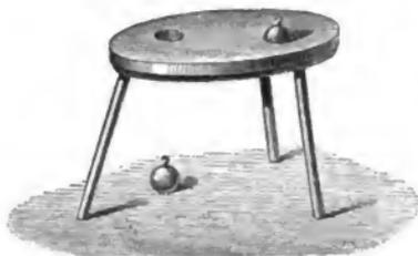
250 Gramm schwere Kupferkugel und eine ebenso schwere Bleikugel gelegt, welche beide in einem mit kochendem Wasser gefüllten Gefäß gelegen haben. Die Kupferkugel wird in kurzer Zeit die Wachsplatte durchschmelzen haben und herabfallen, während die von der Bleikugel abgegebene Wärme die Wachsplatte nicht ganz zu durchschmelzen vermag.
