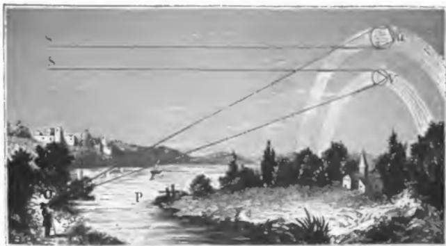
gerade Linie  $OP$ , Fig. 568, gezogen und durch dieselbe eine Verticalebene gelegt; zieht man ferner durch  $O$  eine Linie  $OV$  so, daß der Winkel  $POV = 42^\circ 30'$ , so werden nach dieser Richtung hin sich befindende Regentropfen nach einmaliger innerer Spiegelung wirksame Strahlen ins Auge senden. Aber nicht allein
