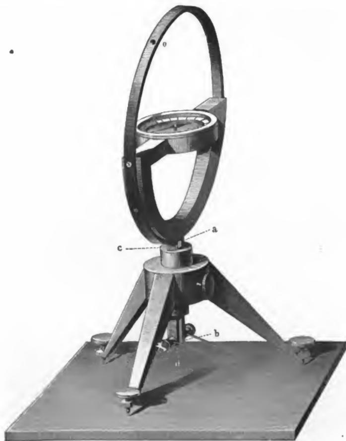
befindet, endet unten mit zwei geraden Kupferstreifen *ab* und *cd*, welche durch ein zwischen dieselben gelegtes Stück Holz oder Elfenbein von einander isolirt sind. Jedes dieser gerade ausgestreckten Enden des kreisförmig gebogenen Streifens trägt unten eine Schraubklemme zum Einschrauben der Zuleitungsdrähte.
