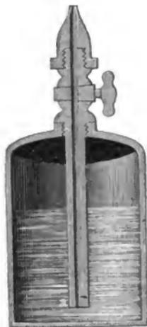
welcher den Hals eines Glasballons verschließt, und zwar geht sie fast bis auf den Boden des zum Theil mit Wasser gefüllten Gefäßes herab. Wenn nun durch ein zweites Rohr *f*, welches dicht unter dem Kork mündet, Luft eingeblasen wird, so wird dadurch die Luft im oberen Theil des Ballons comprimirt und durch ihren Druck ein Wasserstrahl aus der Oeffnung der Röhre *bca* hervorgetrieben.
