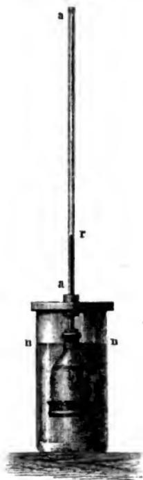
taucht man dann die durch die Blase verschlossene Oeffnung in ein Gefäß mit Wasser, so dringt das Wasser allmählig durch die Blase in die Röhre, so daß in der Röhre die Flüssigkeit steigt, während sie außen sinkt. Umgekehrt sinkt die Flüssigkeit in der Röhre, wenn das Wasser innen, die Lösung des Kupfervitriols außen ist. Etwas von der Lösung des Kupfervitriols dringt freilich auch durch die Blase zum Wasser, wie man bald an der Färbung erkennt.
