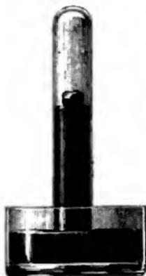
Wenn die Kohle längere Zeit an der Luft gelegen hat, so gelingt der Versuch weniger gut, was sehr begreiflich ist, wenn man bedenkt, daß die Kohle atmosphärische Luft und den in der Luft verbreiteten Wasserdampf absorbiert, und daß dadurch natürlich ihre Absorptionsfähigkeit für andere Gase vermindert wird.
