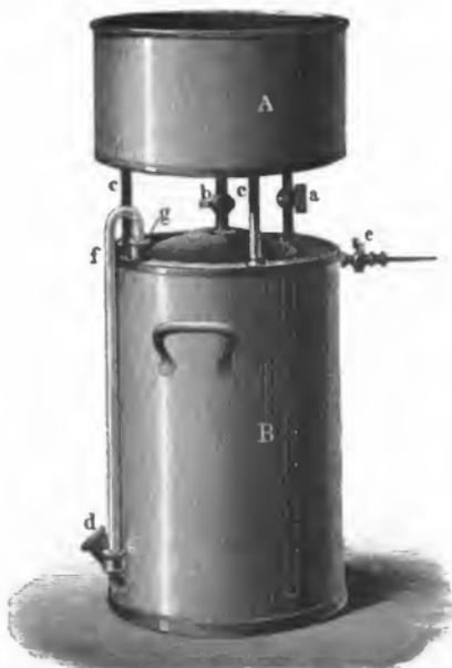
durch einen Hahn verschlossen werden kann und an welcher vorn ein Schraubengewinde eingeschnitten ist, um andere Röhren und Ausströmungsöffnungen anschrauben zu können. Nahe am Boden des unteren Cylinders befindet sich bei *d* eine aufwärts stehende Oeffnung, welche mittelst einer Schraube oder eines Korkes verschlossen werden kann.
