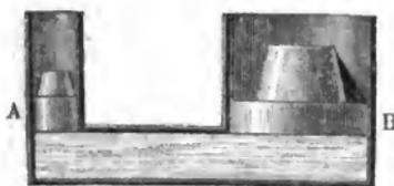
Wenn man also den Kolben *A* mit einer Kraft von 10 Pfund nach innen drückt, so müßte man zur Erhaltung des Gleichgewichts an dem Kolben *C* einen nach innen gerichteten Druck von 40 Pfund aubringen.
