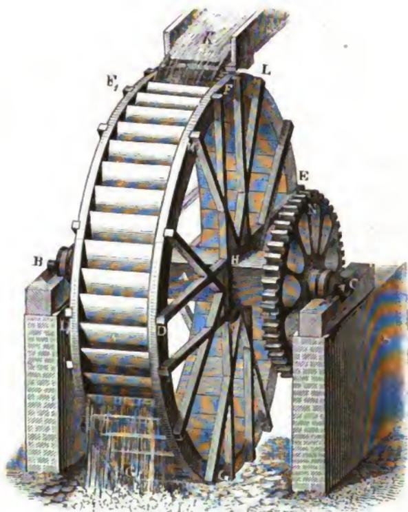
auch darf das Wasser seine Geschwindigkeit doch nicht vollständig an das Rad abtreten, weil ihm sonst keine Geschwindigkeit zum Abflusse mehr bliebe. Somit ist auch bei dem Poncelet'schen Rade ein gewisser Verlust, die Widerstände ungerchnet, unvermeidlich.
