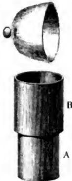
Noch auffallender läßt sich diese Verstärkung des Tones zeigen, wenn man eine durch Streichen mit dem Fiedelbogen zum Tönen gebrachte Käseglocke über eine 5 bis 6 Zoll weite, unten geschlossene Röhre von Pappendeckel hält, Fig. 200, welche eine entsprechende Länge hat. Um diese Länge nach Bedürfniß reguliren zu können, besteht die Röhre aus zwei Theilen, A und B, von welchen der untere unten geschlossen ist, während die obere, etwas weitere Röhre nach Belieben auf- und abgeschoben werden kann.
