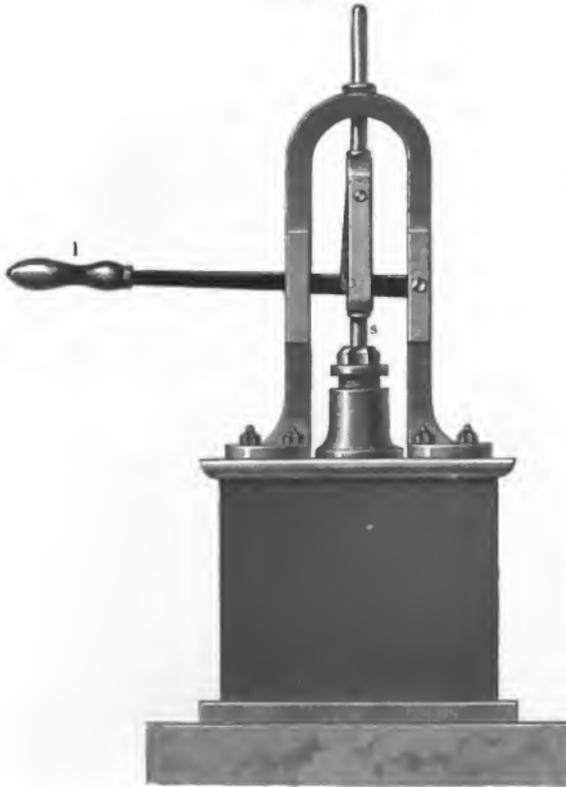
ist, einen gleichen Druck auszuhalten. Ist also der Querschnitt des Kolbens *p* *n*mal so groß als der des Kolbens *s*, so wird der Kolben *p* mit einer Kraft *nk* gehoben.
