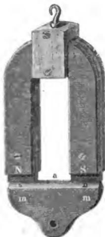
Dagegen ist die Gesamttragkraft eines Hufeisenmagnets weit größer als die Summe der Tragkräfte der einzelnen Pole. Während z. B. ein Hufeisenmagnet 12 Pfund trug, wenn der Anker mit beiden Polen in Verührung war, wie in Fig. 362, konnte der einzelne Pol nur 2 Pfund tragen.
