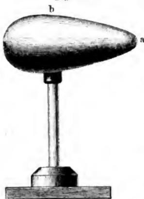
Fig. 402, so findet man, daß die Dichtigkeit der Elektricität an spizen Ende bei *a* am größten, bei *b* aber am kleinsten ist.
