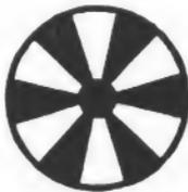
hat; aus demselben Grunde kann man auch die Speichen eines schnell laufenden Rades nicht unterscheiden, und die obere Fläche eines Kreisels, welcher mit abwechselnd weißen und schwarzen Sektoren bemalt ist, wie Fig. 324, erscheint bei rascher Rotation gleichförmig grau. Wenn aber der Kreisel, im Dunkeln rotirend, momentan erleuchtet wird, etwa durch einen Blitz oder einen elektrischen Funken, so kann man die einzelnen Sektoren deutlich unterscheiden.
