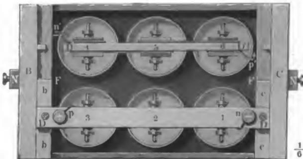
Im Grundriß, Fig. 595, erscheinen die Plattenpaare 1, 2 und 3 durch den breiteren Theil der sie tragenden Holzleiste *D* verdeckt, während die Plattenpaare 4, 5 und 6 so dargestellt sind, wie sie in einem durch die horizontale Oberfläche von *Bb* und *Cc* gelegten Schnitt, von oben gesehen, erscheinen.
