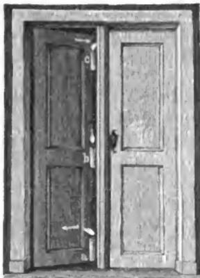
sich die Flamme immer mehr und mehr aufrecht, ungefähr in der halben Höhe der Oeffnung steht sie aufrecht, sie ist hier nicht durch Luftströmung afficirt; bringt man sie aber noch weiter herunter, so wird die Flamme von außen nach innen getrieben. Man sieht also, daß die erwärmte Luft oben aus- und daß dagegen unten die kalte Luft in das Zimmer einströmt.
