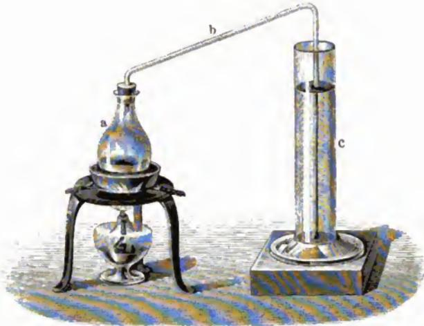
Glasrohr *b* in ein cylindrisches Gefäß *c* geleitet, welches mit kaltem Wasser gefüllt ist. Hier werden nun die Dämpfe wieder verdichtet, die Wärme also, welche bei der Bildung der Dämpfe in *a* gebunden wurde, muß in *c* wieder frei werden, das kalte Wasser in *c* wird also allmählig erwärmt, und aus der hier hervorgebrachten Temperaturerhöhung kann man auf die Größe der latenten Wärme der Dämpfe schließen.
