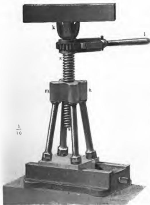
für den Fall des Gleichgewichts an der Schraube zur Last  $Q$  verhalten, wie die Höhe  $H$  des Schraubenganges zum Umfange  $U$  der Spindel, oder es ist
