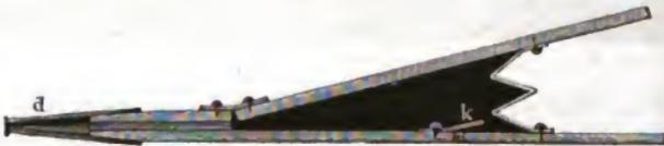
sind wie Fig. 185 zeigt. Die in der oberen Abtheilung *A* eines solchen Blasebalges enthaltene Luft wird durch Gewichte, welche auf dem oberen Deckel liegen,
