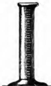
hohen Wasserschicht bedecken würde. Wenn also die in einer bestimmten Zeit gefallene Regenmenge den Cylinder bis zum nten Theilstrich (von unten an gezählt) füllt, so ist in dieser Zeit so viel Regen gefallen, daß er den Boden bis zu einer Höhe von  $\frac{n}{10}$  Millimeter mit Wasser bedeckt haben würde, wenn kein
