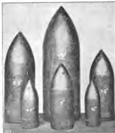
Geschosse nach dem Durchschlagen von 5" bis 12" Panzerplatten.
