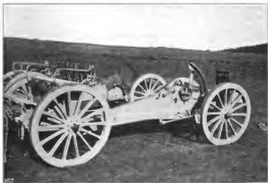
Bild 2. Rimallho-Haubitz. Lafette aufgeprotzt.
