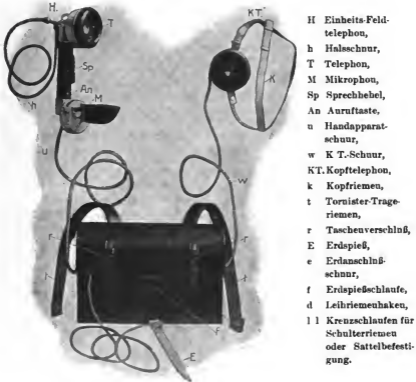
Komplette lautprechende Feldstation im Betrieb.
