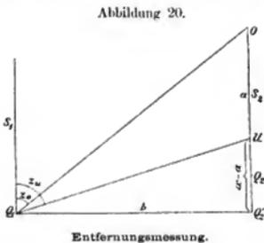
$Q_1$  und  $Q_2$  seien die Eispunkte (Abbildung 20), welche durch die Stangen  $S_1$  und  $S_2$  markiert sind; die gesuchte Horizontalentfernung derselben nenne ich  $b$ . Während ich mit dem Instrument auf  $Q_1$  stand, wurden mir durch Dr. Vanhöffen
