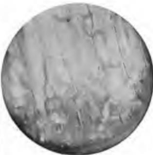
1. Parallele Streifung des Firneises in einem Plattenbündel (Kern) auf einer Schicht, die recht zu den Platten und parallel zur Gefrierfläche.
