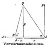
werden müssen, habe ich sie ausserdem in Verbindung mit der Methode des Rückwärtseinschneidens benutzt und die Form der Fehlergleichungen, welche daraus entsteht, schon im vorigen Abschnitt mitgeteilt (Formel 5).
