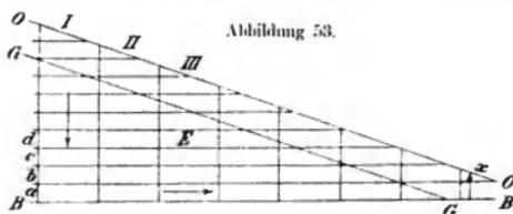
Schematische Zerlegung einer Eismasse in Drucksysteme.
