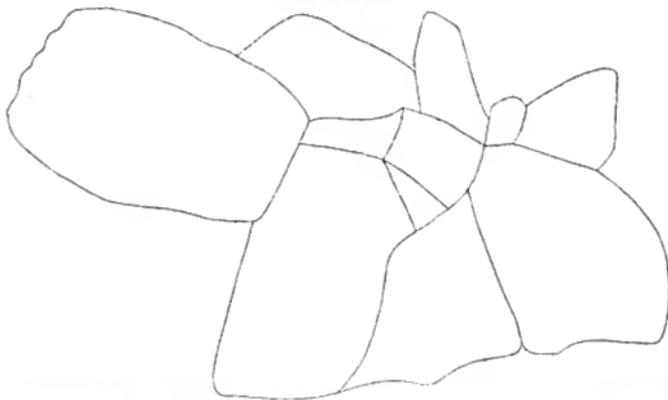
Die Kornstruktur in einem vom Grossen Karajak-Eisstrom abgelösten und in dem Hüttensee bei 160 m Meereshöhe frei liegenden Eisblock.
