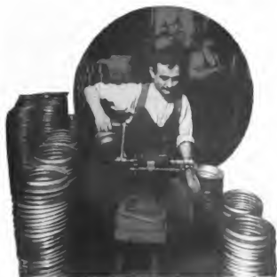
Formwalzen der unteren Hände von Wassereimern
