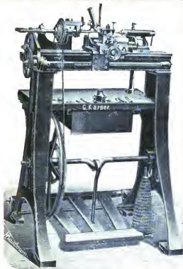
Präzisions-Leitspindelbank No. 1 (Chiffre DL 1) von 80 cm Bettlänge, 40 cm Spitzweite, 110 mm Spitzenhöhe.
