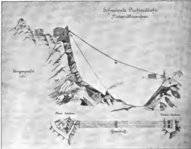
Fig. 12. Schwebende Drahtseilbahn. Pilatus-Klimeshorn.
