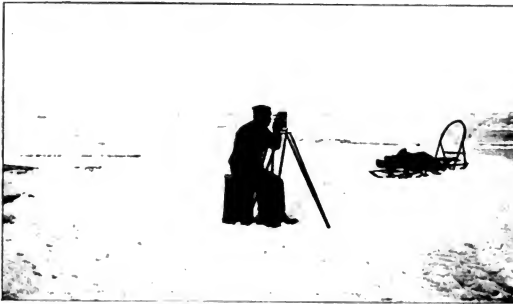
Arbeit mit der Inklinationsnadel (Photographie)
