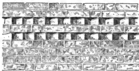
Bild 8. Mittelalterlicher Backsteinverband mit Zahnfries.
