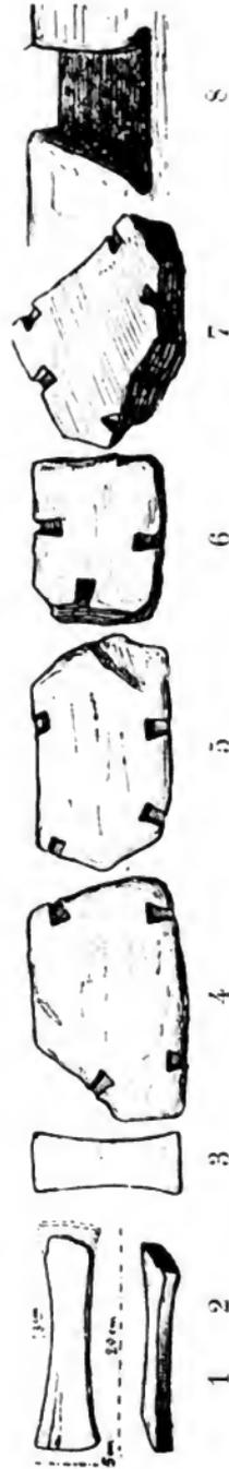
1—3 Schwalbenschwänze aus Eichenholz. 4—8 Mauerquader mit Schwalbenschwanzanschnitten.
