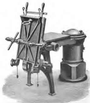
Fig. 48. Kombinerter Stereotypenapparat in zum Gießen fertiger Stellung von J. G. Scheller & Giesecke.
