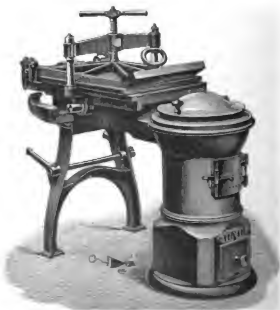
Fig. 49. Kombinerter Stereotypenapparat in zum Trocknen fertiger Stellung von J. G. Scheller & Giesecke.
