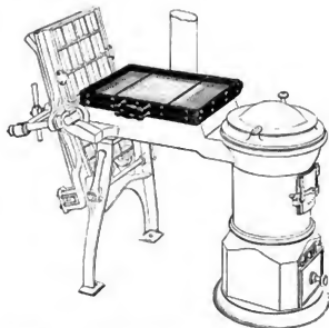
Fig. 46. Kombinerter Stereotypenapparat mit aufgelegtem Trockenrahmen von J. G. Scheller & Giesecke.
